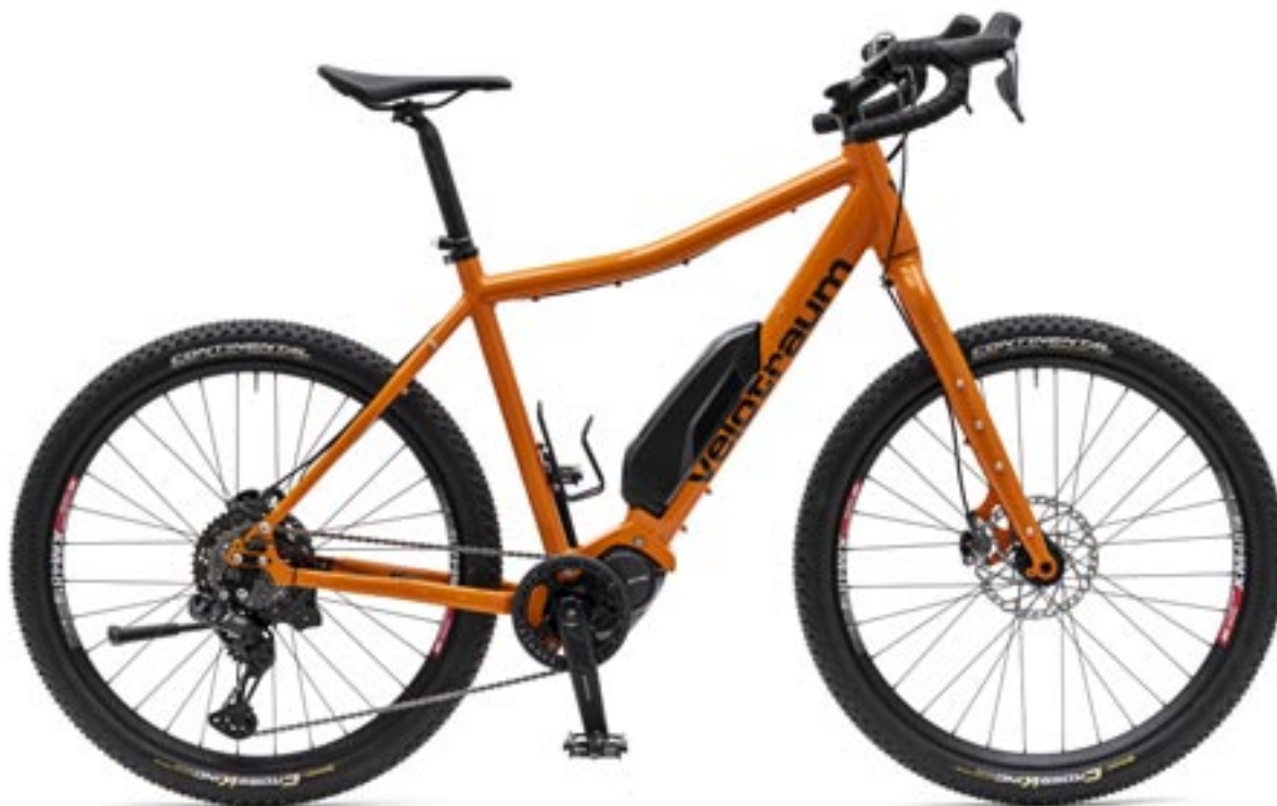
Abbildung: Rahmen E900 – Farbe RAL 2009 – Größe »L« – Reifenformat 57-584 mm – Gewicht: 20,2 kg
