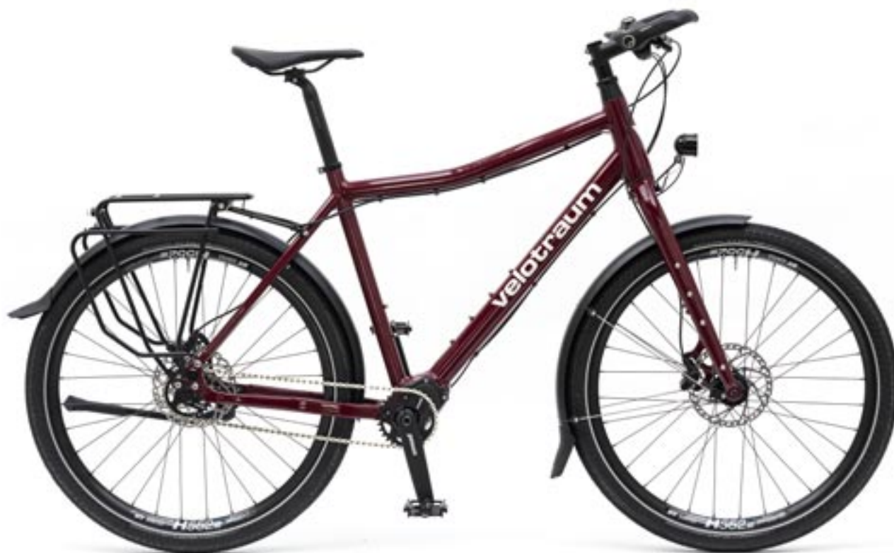
Abbildung: Rahmen F1300 – Farbe RAL 3005 – Größe »XL« – Reifenformat 55-584 mm – Gewicht 16,9 kg Hinweis: Das abgebildete Beispiel für ein »R6« beinhaltet Wahloptionen
